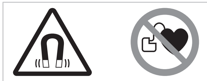
Abb. 9: Warn- und Verbotsschilder auf einem Verdichter mit Permanentmagnetmotor
